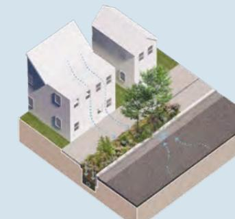
Los desagües biológicos son canales de drenaje con vegetación que pueden capturar, retener e infiltrar la salida, permitiendo que el exceso de agua de lluvia a lo largo de las servidumbres de paso entre en el sistema de canalización de aguas pluviales.
