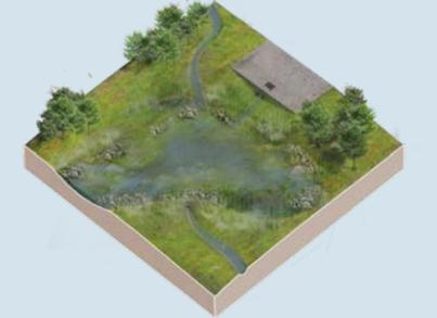
Captar la salida de las aguas y desviarlas corriente arriba puede ayudar a reducir las inundaciones corriente abajo o las inundaciones localizadas y permitir la recarga de las aguas subterráneas. Los estanques de retención, por ejemplo, son cuencas artificiales utilizadas para gestionar la escorrentía de las aguas pluviales y favorecer la infiltración.
