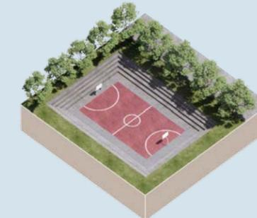
La reconversión de parques y espacios abiertos puede capturar y almacenar las aguas pluviales procedentes de zonas impermeables. A continuación, el agua almacenada se devuelve directamente a las aguas naturales a través de una tubería de salida, a velocidades diseñadas para reducir los picos de caudal durante las tormentas.
