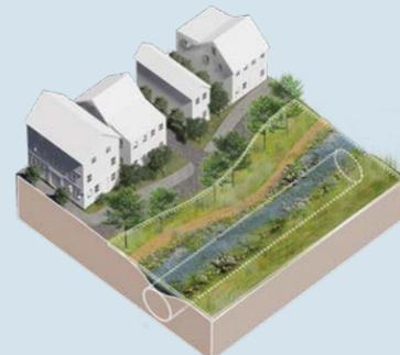
La iluminación natural de los arroyos es la exposición de una parte o la totalidad del caudal de los cursos de agua cubiertos por tuberías o alcantarillas. La iluminación de los arroyos y la restauración de los sistemas naturales de drenaje pueden ayudar a eliminar los problemas de inundaciones al recrear una llanura aluvial y una zona ribereña funcionales.
